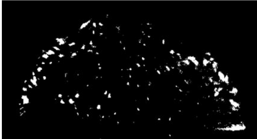
Fig. 112 Exemple d'image prise par la caméra rapide (retravaillée pour augmenter le contraste) et utilisé par le logiciel de micro-PIV.
