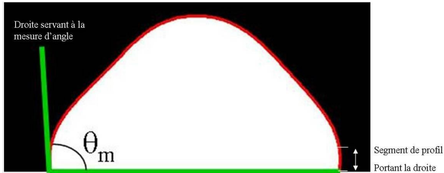
Fig. 43 Méthode de mesure d'angle utilisée pour les gouttes en oscillation.
