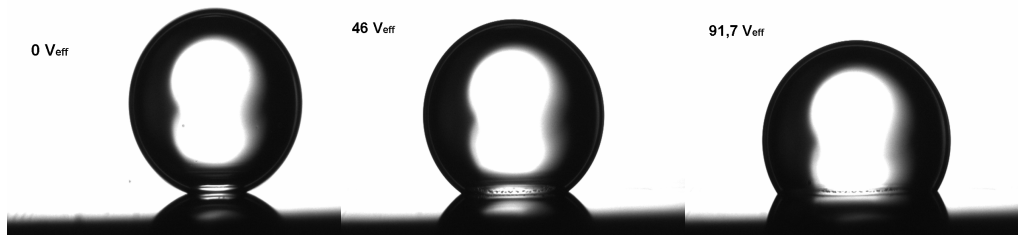
Fig. 54 Etalement d'une goutte de PBS sous l'effet de la tension électrique. Expérience réalisée dans l'huile silicone.
