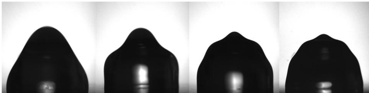
Fig. 88 Profils d'une goutte de PBS soumise à des oscillations induites par l'électromouillage. Sont représentés de gauche à droite les modes 4, 6, 10 et 12; les fréquences du signal électrique sont alors de 216, 393, 835 et 1093 Hz respectivement.
