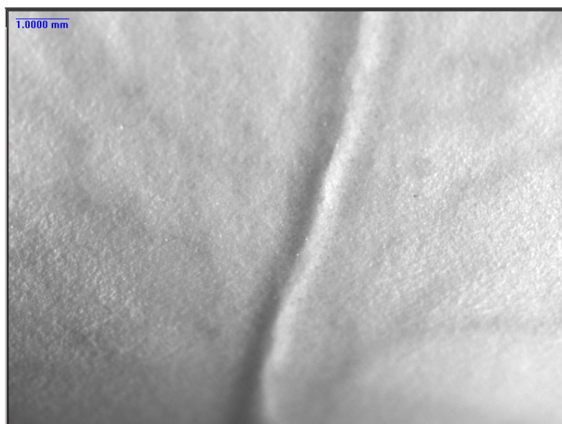
Figure 4.37. Détail de la rayure présente sur la surface de l'isolant dans le voisinage du défaut dans le PT, après plusieurs claquages
