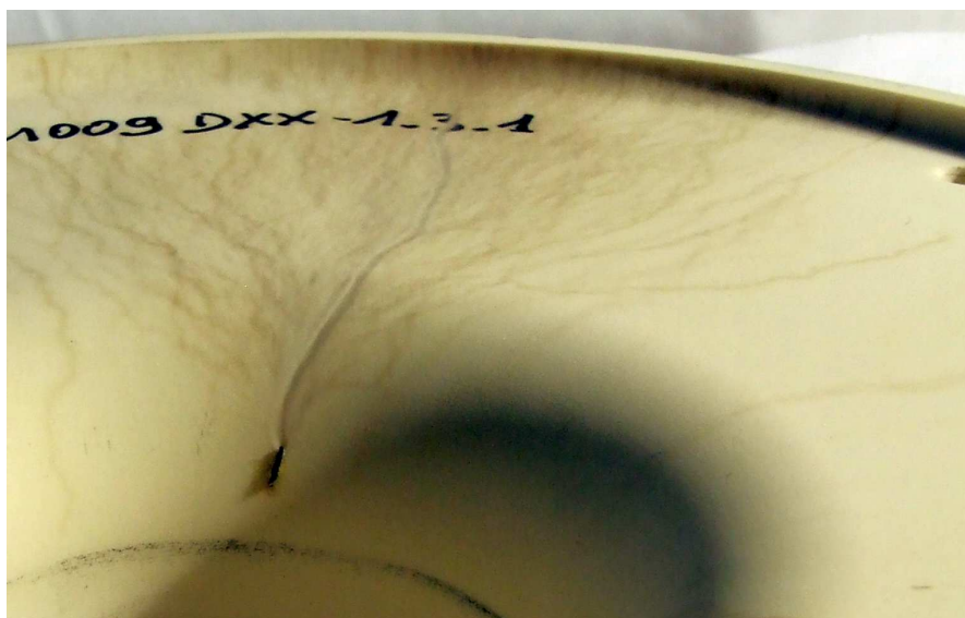
Figure 4.36. La rayure présente sur la surface de l'isolant dans le voisinage du défaut dans le PT, après plusieurs claquages
