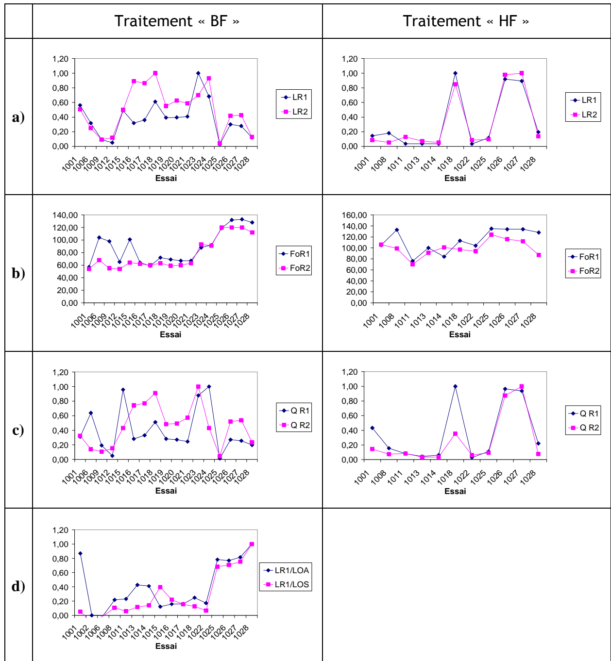
Figure IV.8 : (a) : niveaux des réflexions R1 et R2 (normalisés) ; (b) : fréquences centrales des réflexions R1 et R2 ; (c) : coefficients de qualité des signaux de réflexion (normalisés), (d) : niveaux de réflexion R1 par rapport aux niveaux d'onde aérienne LOA et onde de surface LOS (normalisés).
