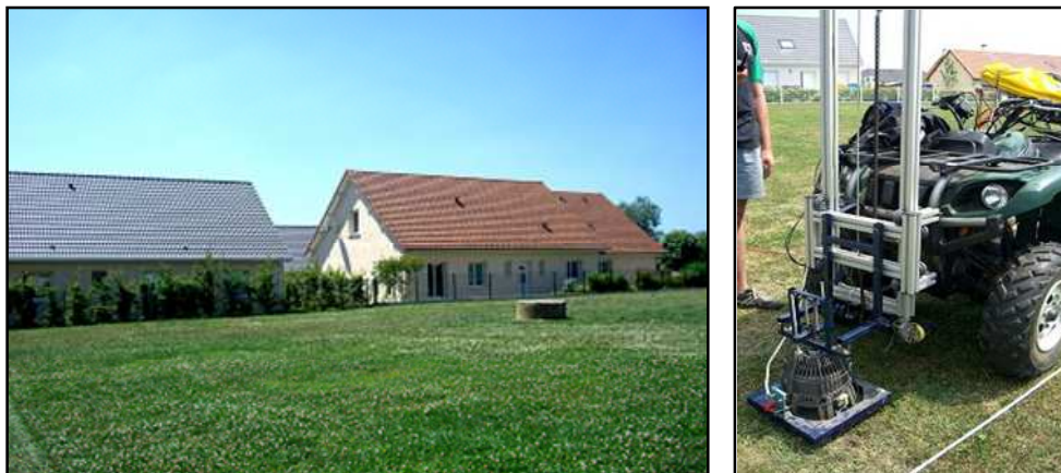
Figure VI.4 : (à gauche) Photographie de la zone au-dessus de la marnière de Goderville. Le puits d'accès est visible sur au milieu VI.1 ; (à droite) : source Vib-PP montée sur le quad et appuyé contre le sol.
