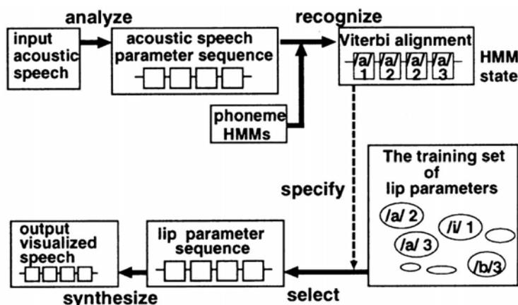
FIG. 3.16 – Schéma de la synthèse des paramètres labiaux à partir d'une méthode basée sur les HMM. D'après E. Yamamoto [88].
