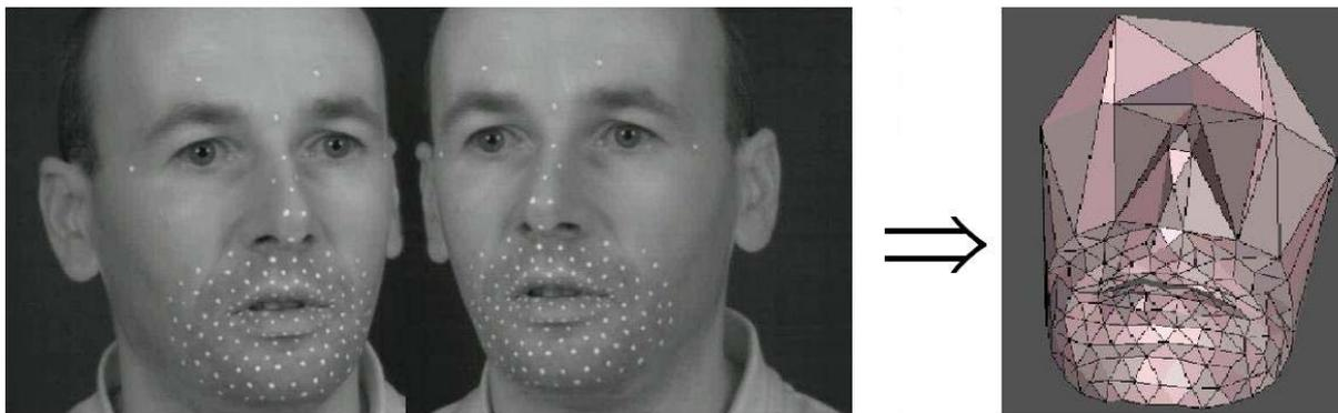
FIG. 4.1 – Construction d'un maillage 3D à partir de deux images stéréo.
