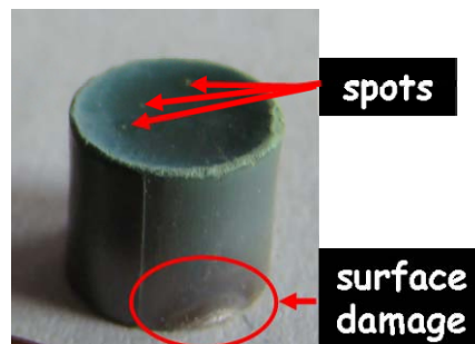
Figure 91 : Photographie du comprimé de nickel fritté sous air (E1). Changement de couleur après frittage (gris → vert). Altérations de la surface causées par des plasmas et des arcs.
