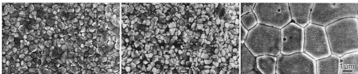
Figure 62 : Microstructure des zircons (a) 2Y, (b) 3Y et (c) 8Y après frittage à 1500°C/2h [MAT 08]
