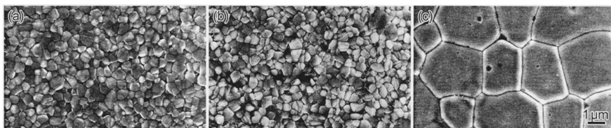
Figure 62 : Microstructure des zircons (a) 2Y, (b) 3Y et (c) 8Y après frittage à 1500°C/2h [MAT 08]
