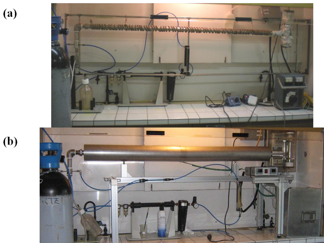
Figure 12 - Photos de l'évolution du réacteur : (a) réacteur initial et (b) réacteur final étanche et isolé thermiquement.
