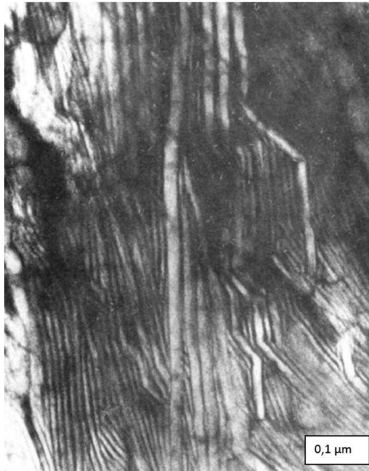
FIGURE 9 – Image obtenue par microscopie électronique d'un polyéthylène cristallisé à 125 °C (masse molaire de 5600 gr/mol) [19]. Les zones noires et les zones blanches représentent respectivement les régions amorphes et les régions cristallines.
