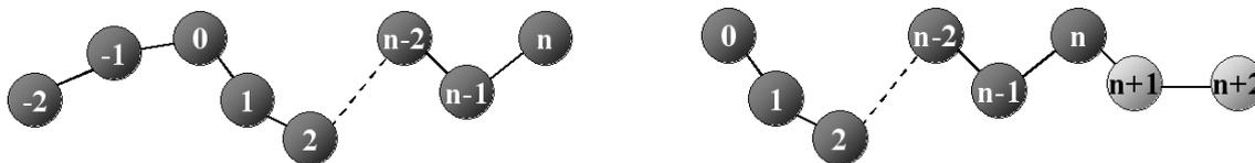
FIGURE 21 – Reptation : les atomes effacés (-2 et -1 à gauche) sont reconstruits à l'autre bout de la chaîne (n+1 et n+2 à droite) créant un mouvement de reptation de l'ensemble de la chaîne.
