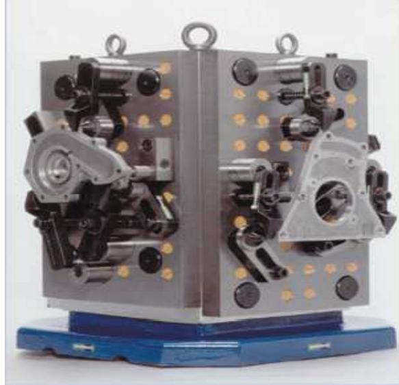
Figure 1.4 Groupement de pièces sur le même montage. [Nor00]
