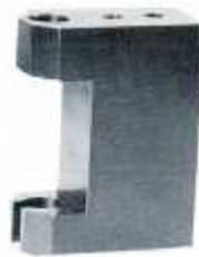
Figure 3.51 Bloc de bridage. [Nor00]
