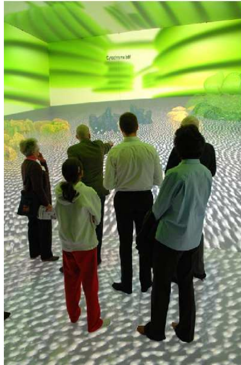
FIG. 11: Dispositif de réalité virtuelle, le C6. Des couples d'images sont rétro-projetés sur les faces du cube permettant une vision stéréoscopique omnidirectionnelle. Source : [VRA]
