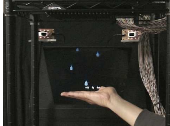
FIG. 24: Touchable Holography, une interface haptique sans contact. Des ultrasons sont émis et génèrent un champ de pression, l'utilisateur ressent sur sa main les gouttes de pluie qui tombent. Source : [HTNS09]
