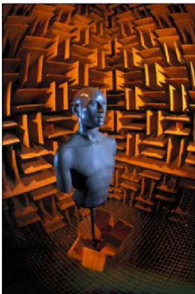
FIG. 37: Mannequin en salle anéchoïque pour la mesure des fonctions de transfert génériques. Source : [NIS]
