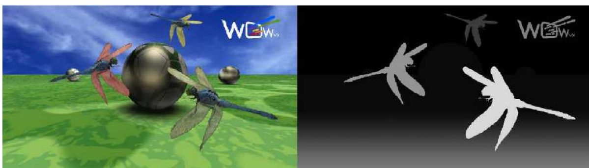
FIG. 68: Écran autostéréoscopique. À gauche l'image affichée. À droite la carte de profondeur en niveau de gris associée à l'image affichée. La carte de profondeur permet de connaître la profondeur de chaque pixel affiché. Source : [Phi08]
