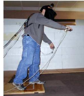
FIG. 67: Mesure physiologique pour la présence. Le participant porte un visiocasque et l'équipement nécessaire pour les mesures physiologiques. Le sujet marche sur une planche pour simuler la sensation de vide. Source : [MIWB02]
