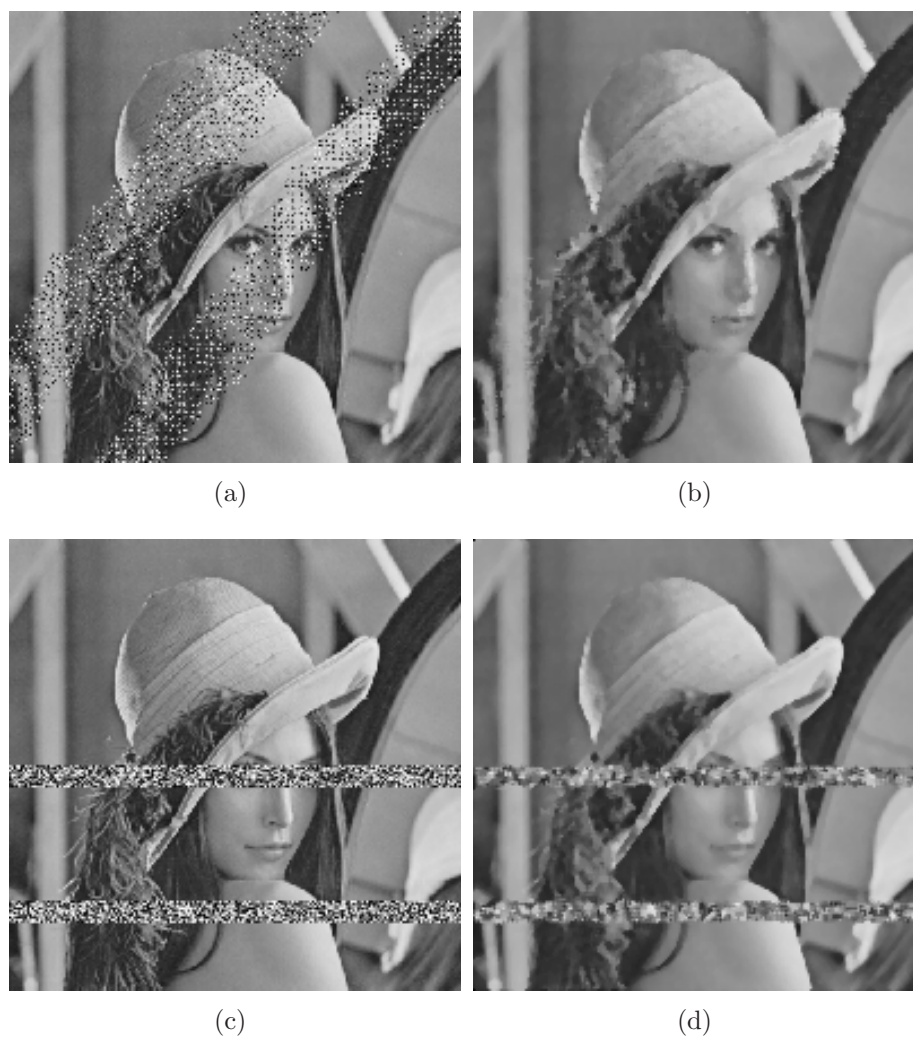
Figure 4.9 – (a) Reconstruction après la perte 2 paquets, contenant chacun 2000 points. (b) Restauration de (a) avec un filtre médian 3 \times 3 . (c) Perte équivalente à (a) (2 fois 2000 pixels consécutifs perdus), mais dans le cas d’une transmission ligne par ligne. (d) Filtrage de (c) avec un filtre médian 3 \times 3 .
