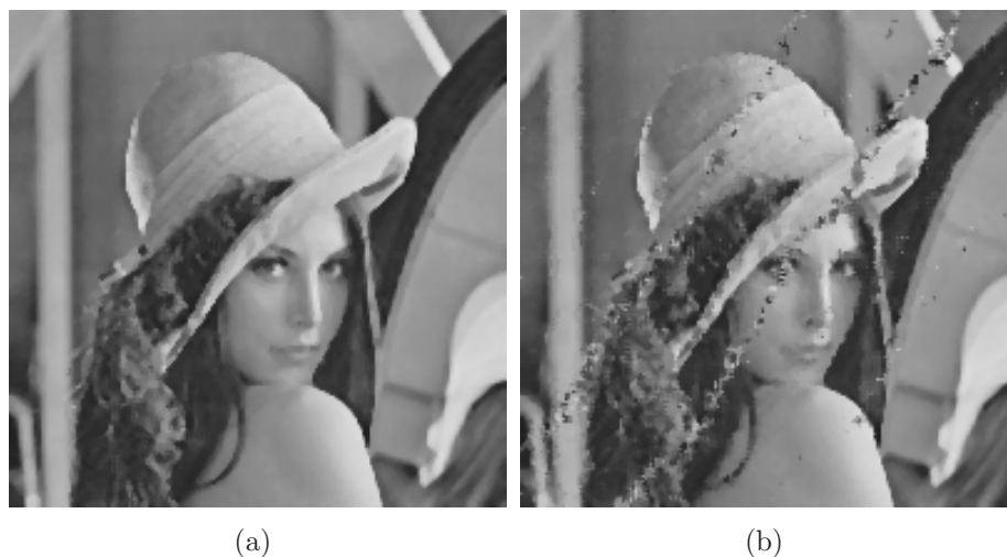
Figure 4.8 – Restauration de Lena par un filtre médian 3 \times 3 après transmission (a) par paquets de 50 points et 1% de pertes, (b) par paquets de 200 points et 20% de pertes.
