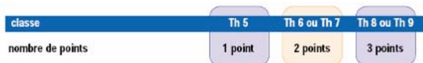
Figure 38 : Exemple de points attribués en fonction des performances thermiques globales de matériaux d'isolation des parois vitrées (menuiseries extérieures) pour l'application de la RT 2000. [DGUHC, 2001].
