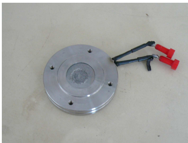
Figure II.1 : Photographie de la cellule de cyclage permettant le suivi de l'évolution du matériau actif au cours de l'intercalation du lithium, par diffraction des rayons X in situ .
