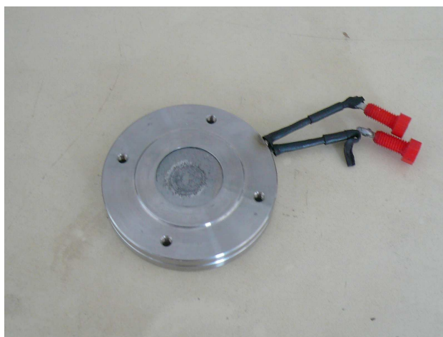
Figure II.1 : Photographie de la cellule de cyclage permettant le suivi de l'évolution du matériau actif au cours de l'intercalation du lithium, par diffraction des rayons X in situ.
