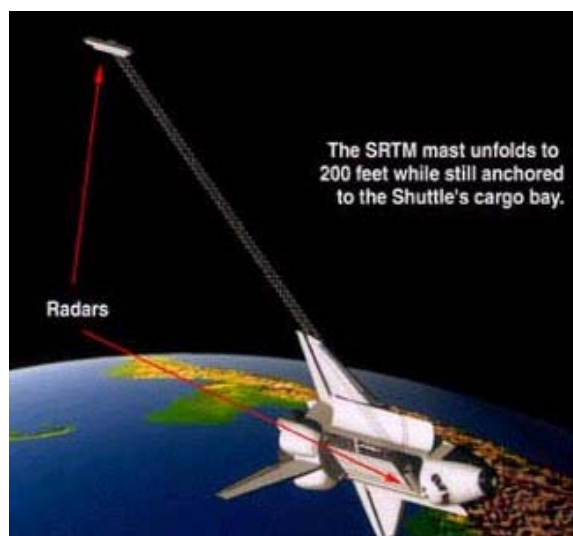
Fig.2 : Photo montrant le principe d'interférométrie single pass
