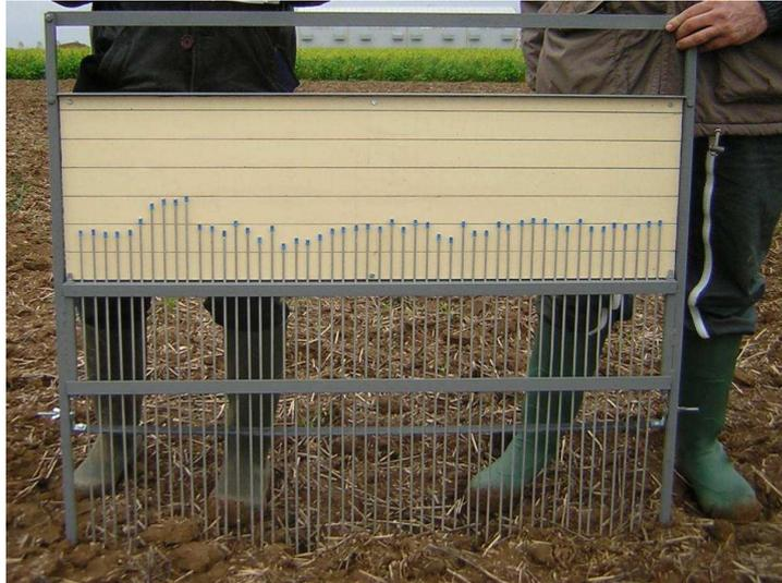
**Figure 1. 8 :** Photo d'un rugosimètre à aiguilles
