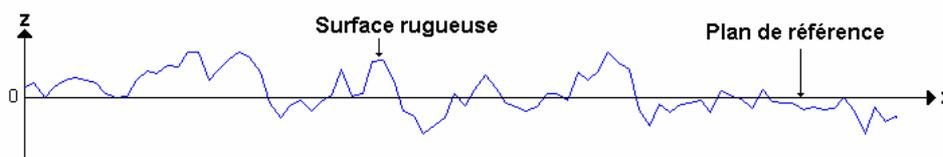
**Figure 1. 6** : Profil d'une surface rugueuse
