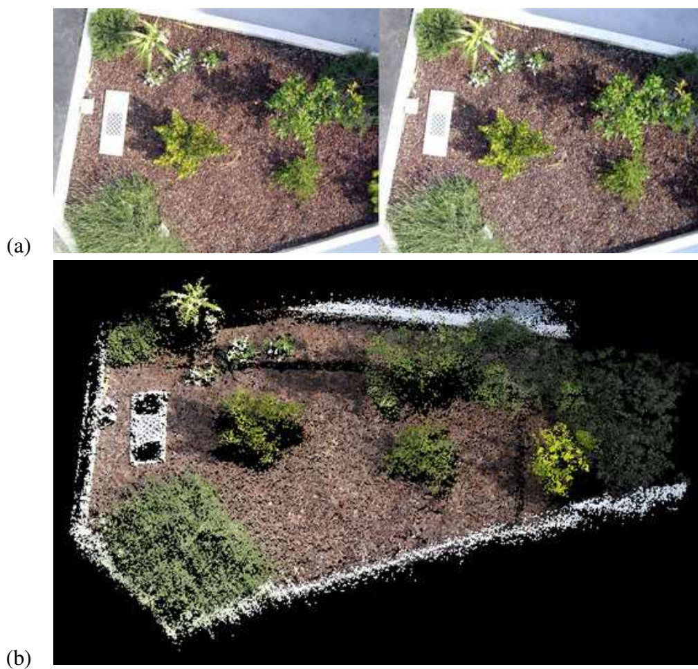
FIGURE 4.24 – Nouvelles acquisitions simultanées pour des applications de stéréorestitution. — (a) Couple stéréoscopique acquis à 7 mètres de hauteur sol avec une taille de l'échantillon au sol de 1,5 millimètres. — (b) Nuage de points 3D obtenu par B. Petitpas. La meilleure qualité des images sources augmente la capacité de l'algorithme à reconstruire un nuage dense. Source : ©ATIS/Petitpas
