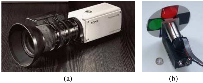
FIGURE 2.14 – Caméra industrielle — (a) DXC-9000, 659 \times 494 , 60 images/secondes, 790 g Source : Sony — (b) JAI CV-M50 IR, Monochrome visible et infrarouge, 752 \times 582 , 25 images/secondes entrelacées, 230 grammes. Ici, monté par Vioix [2004] avec une roue de filtre.
