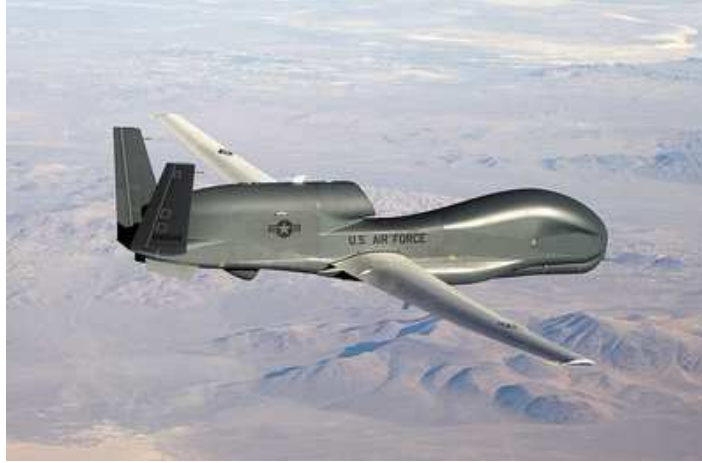
FIGURE 2.5 – Un RQ-4 Global Hawk, appareil de reconnaissance américain qui a l’envergure d’un avion de ligne mais est piloté à distance par liaison satellite. Source : U.S. Air Force photo Wikimedia/Bobbi Zapka
