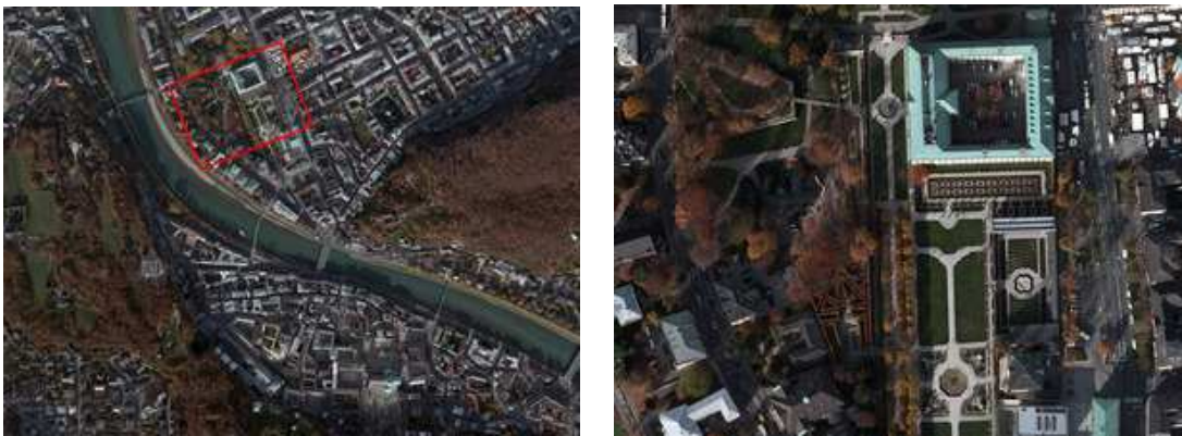
FIGURE 2.20 – Les systèmes en bloc, comme l'Ultracam-XP permettent de fournir de très grandes images, avec une résolution fine, ce qui serait trop coûteux avec un seul capteur. Source : Terra Messflug GmbH
