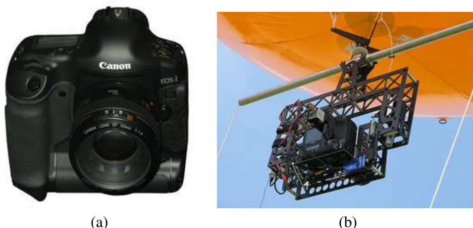
FIGURE 2.1 – Caméra aéroportée petit format : (a) Canon EOS 1Ds Mk II Source : Wikimedia/Rama — (b) Support et électronique de contrôle (ici pour dirigeable) Source : Aero Drum ltd, rc-zeppelin.com
