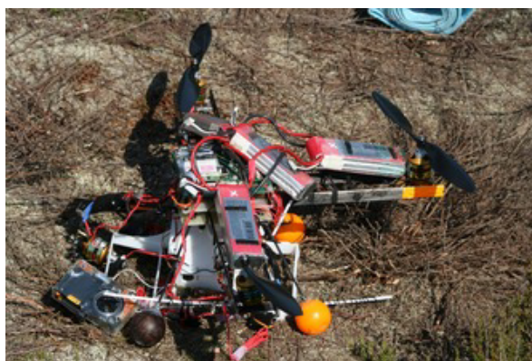
FIGURE 4.9 – À cause de la chaleur, une hélice s'est brisée en vol après 4h de mission et 35 minutes de vol cumulés. Sur un appareil à quatre rotors, la perte d'une hélice est fatale. Source : ©ATIS
