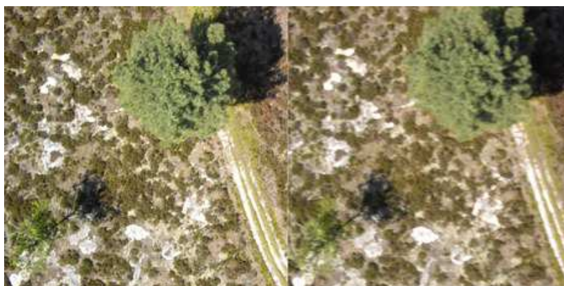
FIGURE 4.11 – Flou de filé dans les images. Les deux extraits sont tirés de deux images successives. Acquisées avec la même taille de l'échantillon au sol de 1,2 centimètres, l'image de droite présente un fort flou de filé qui supprime tous les détails de l'image. La seule solution reste de sous-échantillonner l'image. Source : ©ATIS
