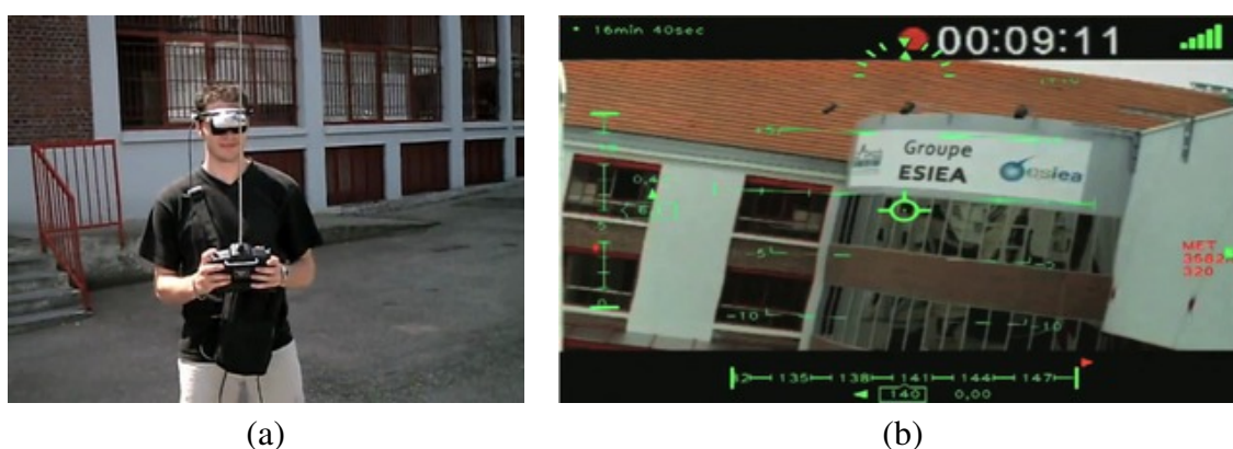
FIGURE 3.29 – Head-Up Display . — (a) Retransmise sur des lunettes de réalité virtuelle, la vidéo embarquée, augmentée des symboles de navigation, permet au pilote de voler comme s’il était à l’intérieur de l’appareil. — (b) Les symboles permettent de compenser le manque de sensation physiques en redonnant au pilote des informations sur la hauteur, l’horizon, etc. Source : ©ATIS / S. Monat
