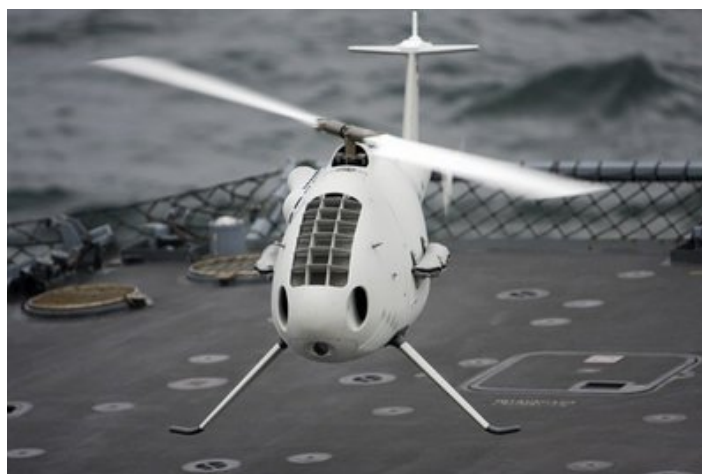
FIGURE 2.7 – Le drone hélicoptère Camcopter S-100 de Schiebel en phase d’atterrissage. La procédure est totalement automatique, malgré les mouvements du bateau. Source : ©MarineBuzz.com
