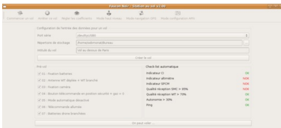
FIGURE 3.31 – Phase de vérification du protocole de mise en route, grâce à la station sol.
