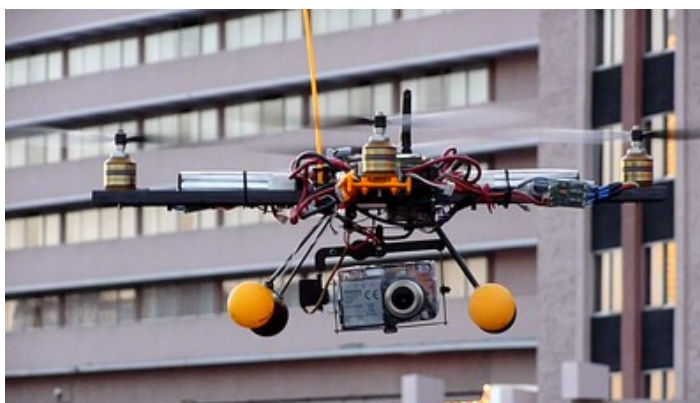
FIGURE 3.8 – Le micro-drone Faucon noir développé durant la thèse. Source : ©ATIS/Gademer
