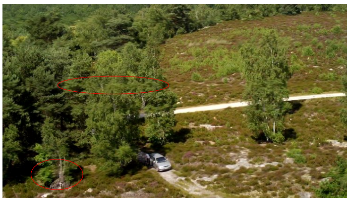
FIGURE 4.10 – « Rolling shutter » sur les vidéos de la mission, les vibrations rendent les vidéos inexploitable. Source : ©ATIS
