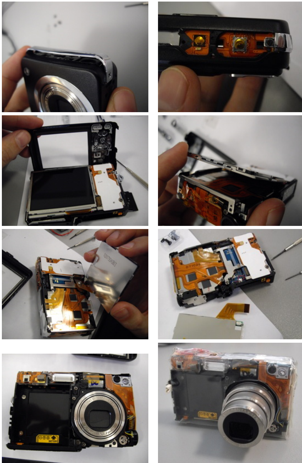
FIGURE 3.17 – Démontage de l’Optio A40. En partant de la coque extérieure, jusqu’aux circuits électroniques, il faut identifier et numérotier chaque pièce pour pouvoir remonter les parties essentielles. En haut à droite, les boutons d’allumage et de déclenchement. Source : Gademer
