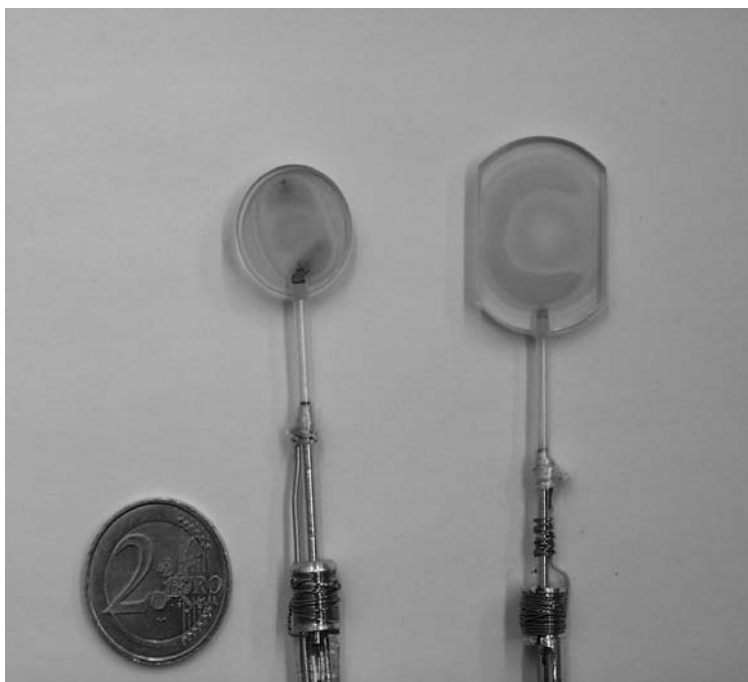
FIG. 2.1 – Photographie de cellules minces : à gauche fenêtre en YAG (30 à 1300 nm), à droite fenêtre en saphir (200 à 600 nm)
