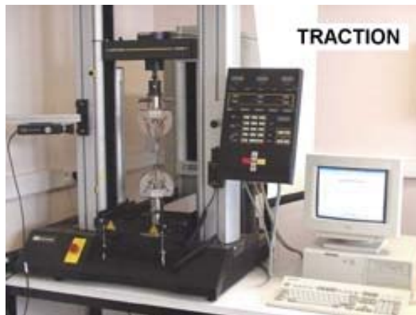
Fig. II.20 : Machine de traction (Instron modèle 4466) utilisée pour les mesures mécaniques contrainte-déformation.
