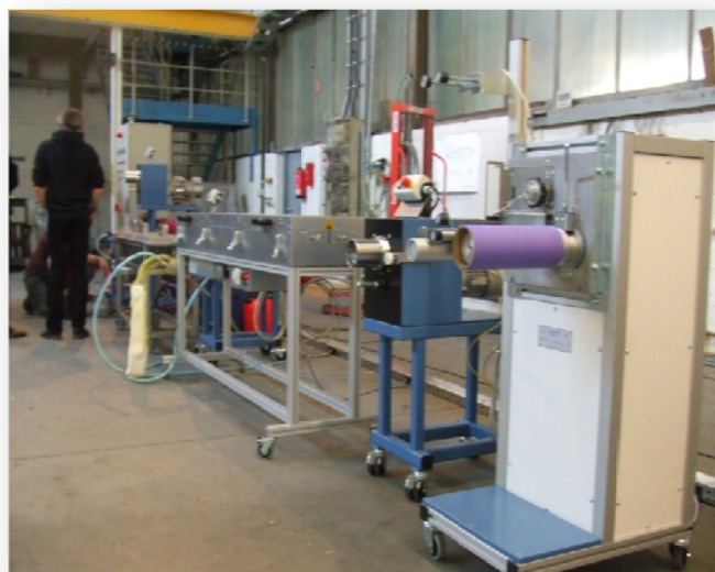
Photographie du montage de filage linéaire lors de sa conception en Allemagne par la société Fourné.
