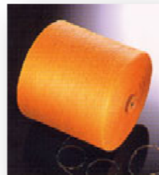
Figure I-2 : Structure chimique de la fibre Zylon®. Rouleau de fibre Zylon HM commercial [Toyobo]
