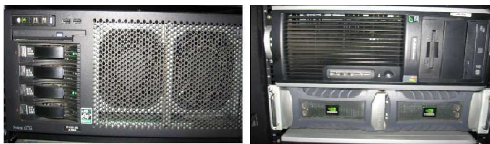
FIGURE 3 – A gauche une machine à multiprocesseurs et à droite un ordinateur utilisant des cartes graphiques
