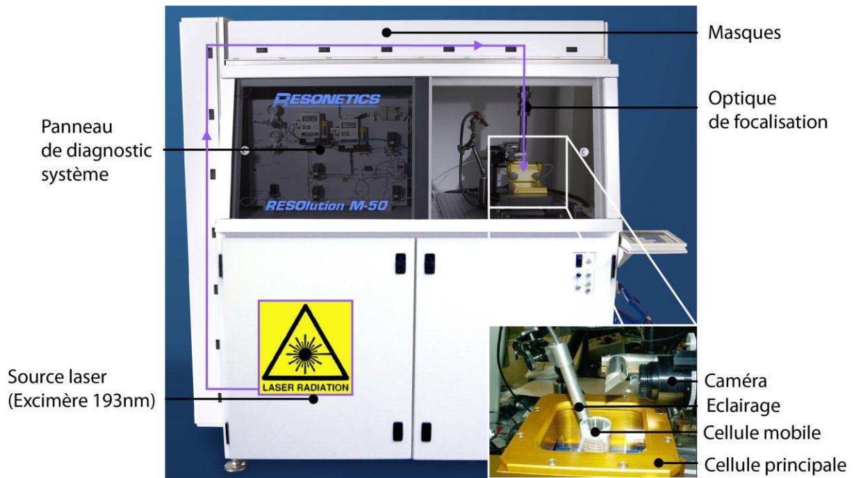
Figure II-20 : Système d'ablation laser intégré Resonetics « RESOLUTION M-50E ».
