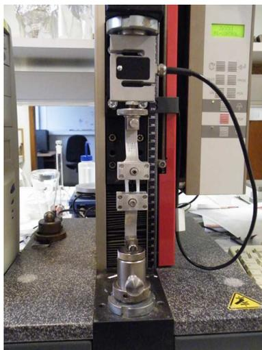
Figure III-10 : Photo de l'appareil de traction
