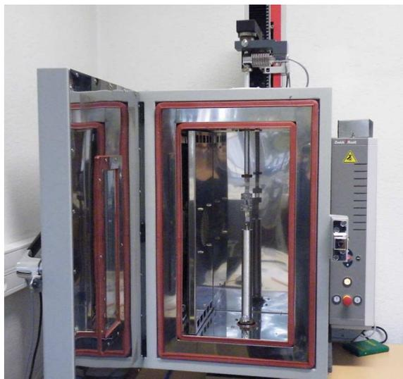
Figure III-11 : Photo de l'appareil des essais de thermo-mécanique
