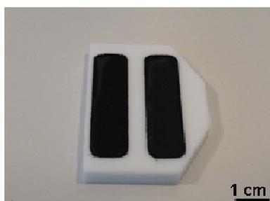
Figure III-2 : Cliché de film SBM/NTC sur le moule en téflon après séchage
