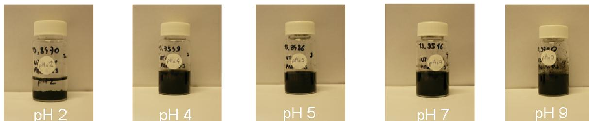
Figure II-15 : Clichés de dispersions de ratio PAA/MWNTs de 0.3 avec une durée de passage aux ultrasons de 100 minutes à différents pH 2, 4, 5, 7 et 9.
