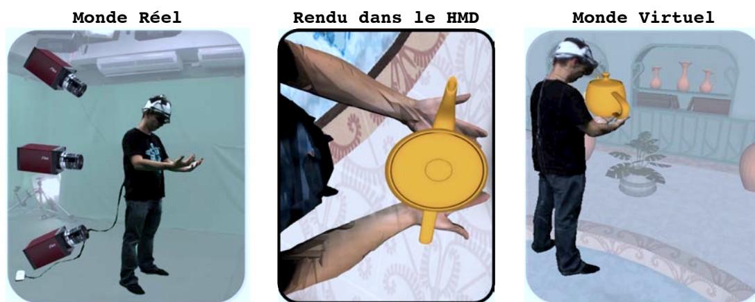
FIGURE 4.8 – Configuration de notre système avec visualisation et interaction à la première personne et mixage correct réel/virtuel.
