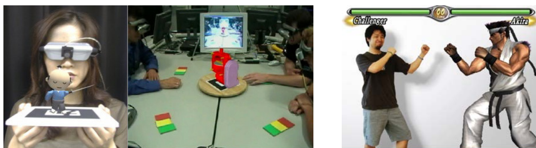
FIGURE 2.8 – Le système ARToolKit basé sur la reconnaissance de marqueur et une de ses applications (gauche), et un jeux basé sur la caméra EyeToy TM de Sony Playstation ® (droite).
