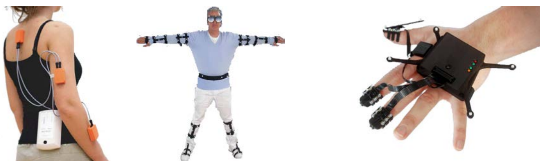
FIGURE 2.5 – Un système Xsens ® basé sur des centrales d’inertie (gauche), et deux systèmes A.R.T. ® basé sur des marqueurs passifs, l’un pour le suivi du corps entier (milieu) et l’autre pour le suivi de la main (droite).
