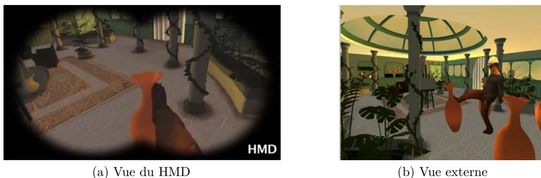
FIGURE 4.13 – Interaction avec un vase virtuel. Les collisions entre le clone numérique et le vase sont gérées par le logiciel de simulation physique SOFA.
