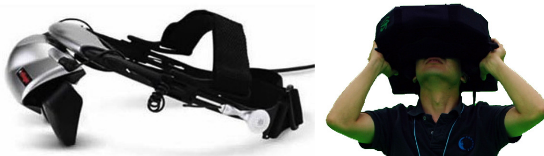
FIGURE 2.2 – Exemples de HMD : le eMagin Z800 (gauche) et le Virtual Eye (droite).
