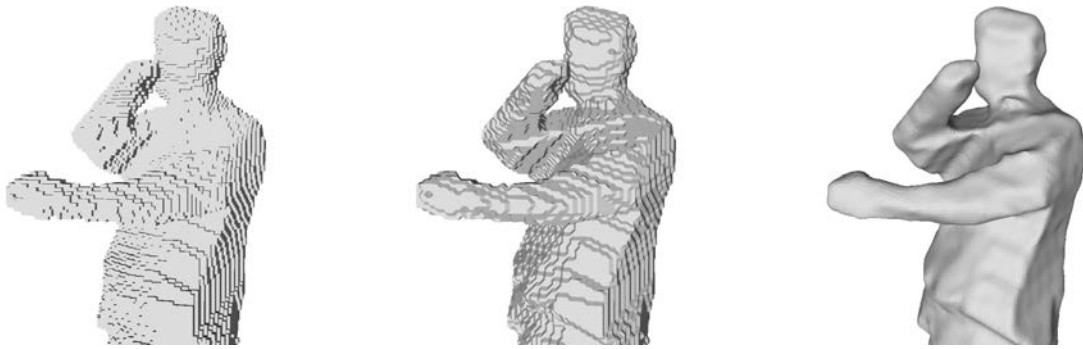
FIGURE 2.13 – Exemple de reconstruction 3D volumique par octree : modèle voxélique à gauche, après une étape de Marching Cube au milieu, et après lissage à droite.
