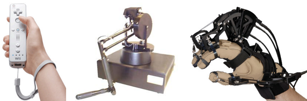
FIGURE 2.4 – Une Wiimote ® (gauche), un Phantom ® (milieu) et un CyberGlove ® (droite).
