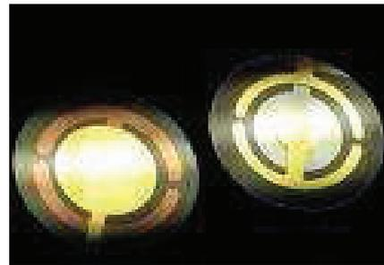
Figure II.6 : Pastille de quartz utilisée dans la microbalance.
