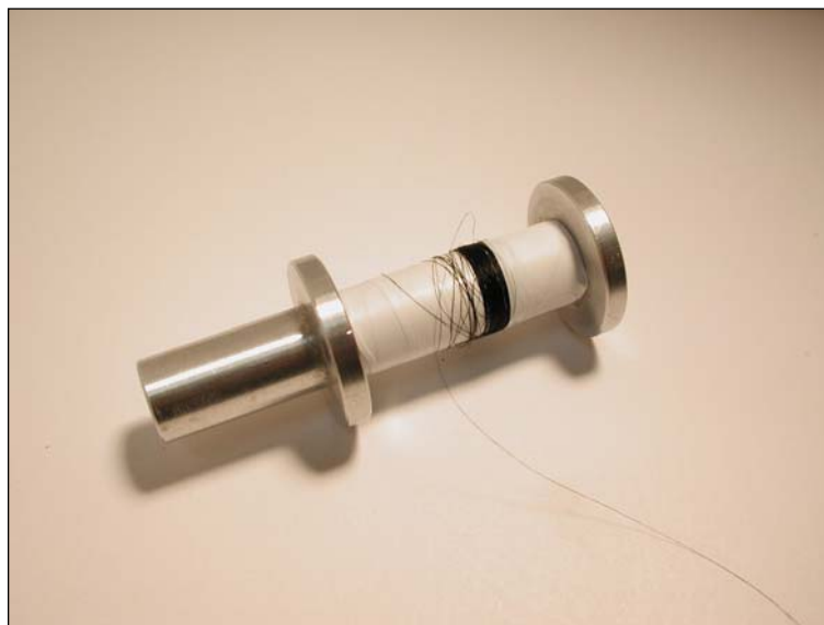
Figure III-6 – Photo d'une bobine de fibre de nanotubes multiparois (Atofina) issue d'une seule expérience. Longueur approximative : 20 m
