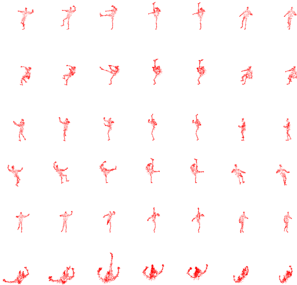
FIG. 5.6 – Les observations pour 7 trames : les points de l'axe médian de l'enveloppe visuelle suivant les 6 points de vue des caméras utilisées.
