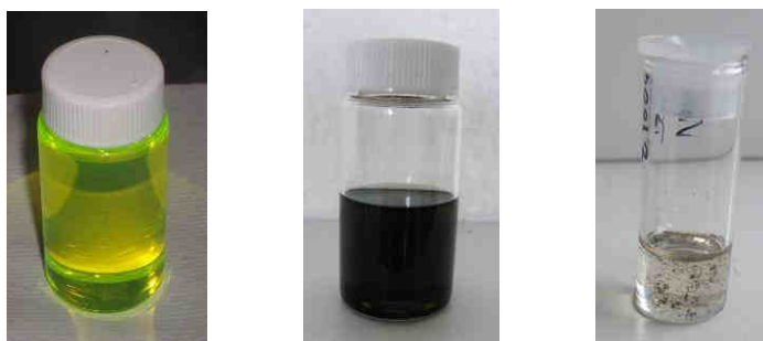
Figure I-4 : Clichés des solutions de pérylène de référence seul (gauche), de nanotubes fonctionnalisés (milieu) et de nanotubes bruts (droite) après centrifugation à 5000 tours par minutes pendant 15 minutes. Les concentrations en pérylène dans les deux solutions ne sont pas équivalentes. Les nanotubes présentés ici ont été fonctionnalisés à partir du rapport de réactifs C/K_{\text{réactif}}=250 .
