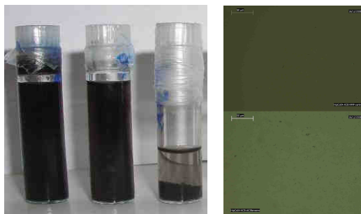
Figure III-7 : A gauche : solutions des nanotubes de carbone fonctionnalisés avec le 4'-cyano[1,1'-biphényle]-4-oxypentyle dans le 1,2-dichlorobenzène (gauche), N-méthyl-2-pyrrolidone (milieu) et chloroforme (droite). A droite : observations sous microscopie optique des solutions dans le N-méthyl-2-pyrrolidone (haut) et 1,2-dichlorobenzène(bas). L'échelle est de 50μm.
