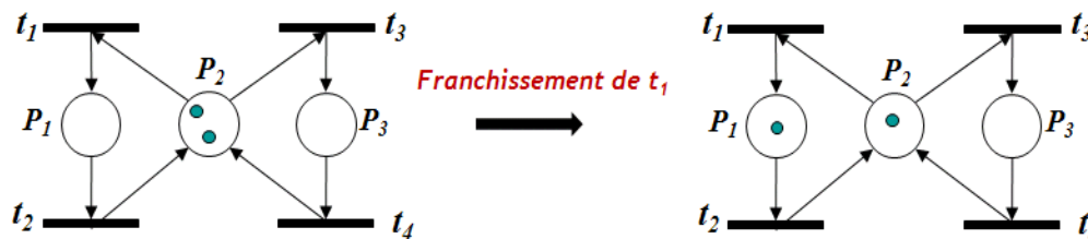
Figure 3.44: Franchissement d'une transition
