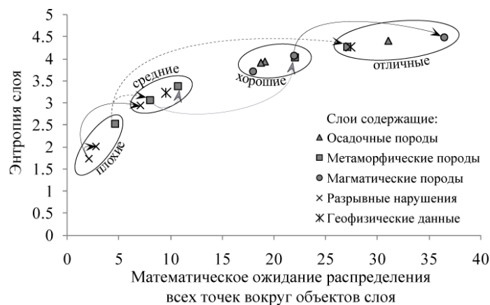
Рис. 4.3 Классификация слоев, содержащих геолого-геофизические объекты, на основе энтропии и математического ожидания ожидаемого распределения (для всех точек области)
