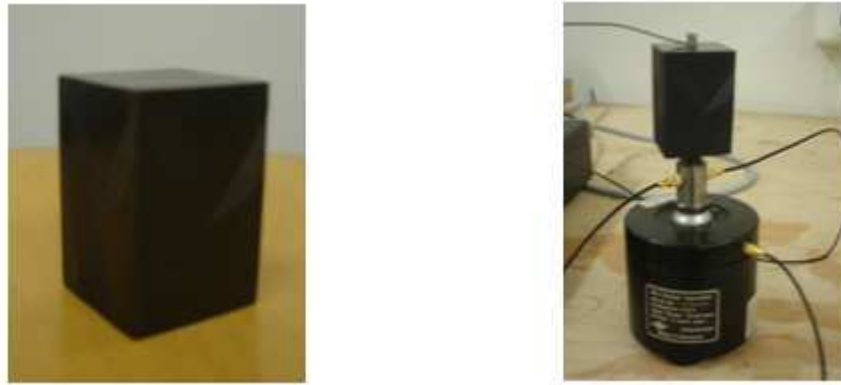
FIG. 4.11. Eprouvette pour mesurer le facteur de perte et sa mise en place pour le composite C 280
