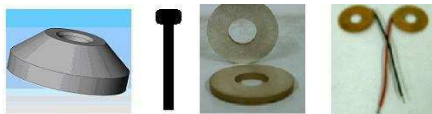
FIG. 2.7. Les composants du convertisseur (de gauche à droite : la masse, la vis, les anneaux piézoélectriques et les rondelles)
