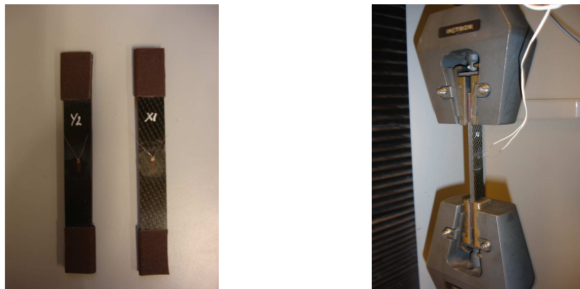
FIG. 4.4. Epreuve de l'essai de traction et sa mise en place avec la machine Instron 20 KN
