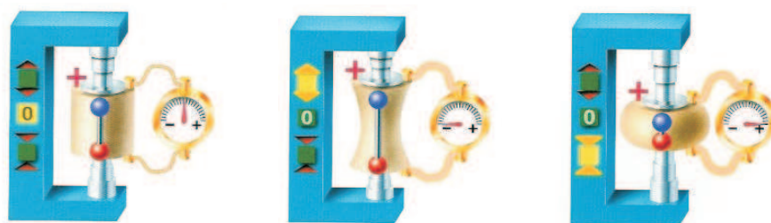
FIG. 2.23. Effet piézoélectrique direct [24]
