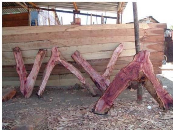
**Photographie 85 : Membrures en *sarigavo* dégrossies puis dressées à l'herminette sur les cotés pour y tracer la forme de la coque à l'aide d'un gabarit**
