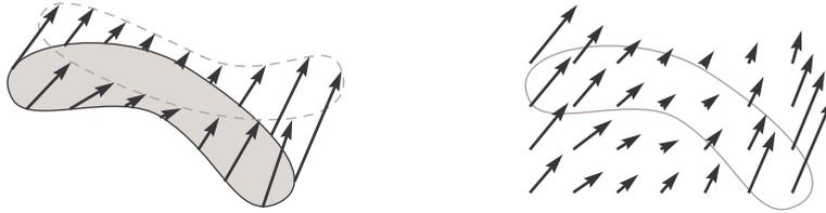
FIG. 8.1 – À gauche : mouvement des points de la surface lorsque l'objet se déplace et se déforme. À droite : un exemple de champ de déplacement pour les points au voisinage de l'objet.
