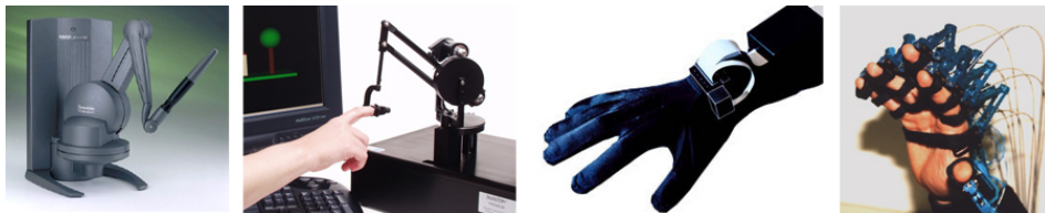
FIG. 5.2 – À gauche, deux versions du bras articulé PHANTOM . À droite, des gants de données, dont le Data Glove .
