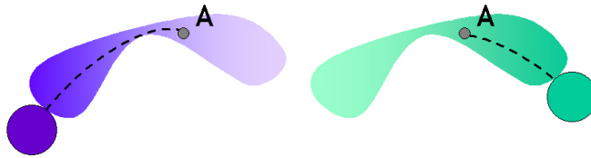
FIG. 3.18 – La pseudo-distance d'un point du matériau à un outil est calculée en suivant la forme du matériau.
