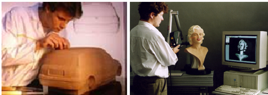
FIG. 2.1 – Beaucoup de formes tridimensionnelles sont encore réalisées en deux temps, par digitalisation d'une sculpture réalisée en argile ou avec d'autres matériaux.
