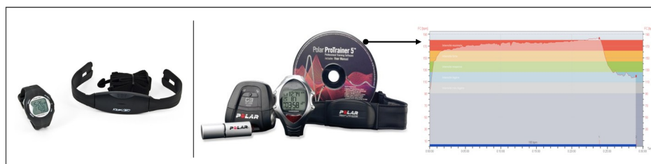
Figure 12 : Deux modèles de cardiofréquencemètre, dont le Polar RS 800® muni d'une transmission infrarouge permettant l'exploitation des résultats par un logiciel informatique
