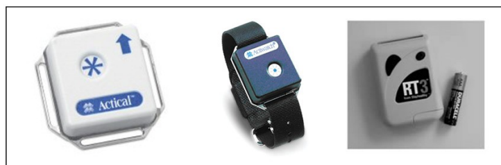
Figure 11 : Plusieurs modèles d'actimètres, de gauche à droite, l'Actical ® et l'Actiwatch ® de type uniaxial, et le RT3 ® de type triaxial
