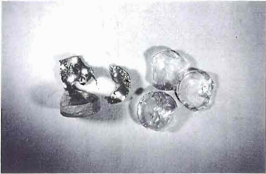
Photo IV-3 : Photographie de l'état de la capsule de Pt après trempe dans le piston cylindre
