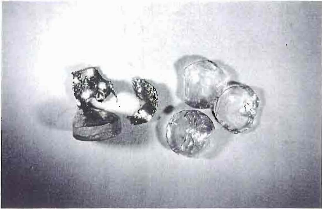
Photo IV-3 : Photographie de l'état de la capsule de Pt après trempe dans le piston cylindre
