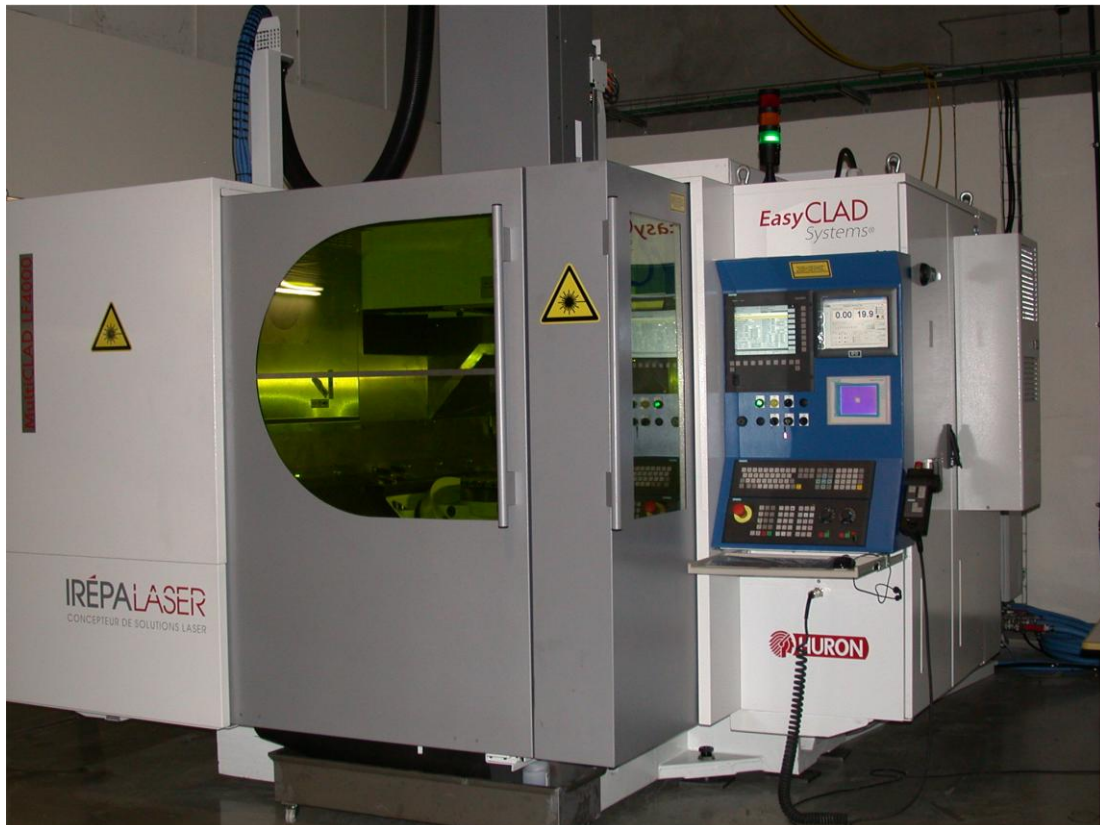
Figure 118 : Machine de projection de poudre de l'IRCCyN procédé CLAD
