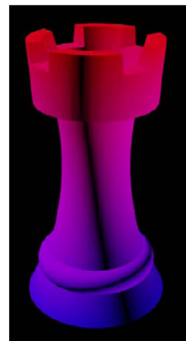
Figure 14 : Exemple de description d'une pièce multi-matériaux (FGM) avec le nouveau format AMF
