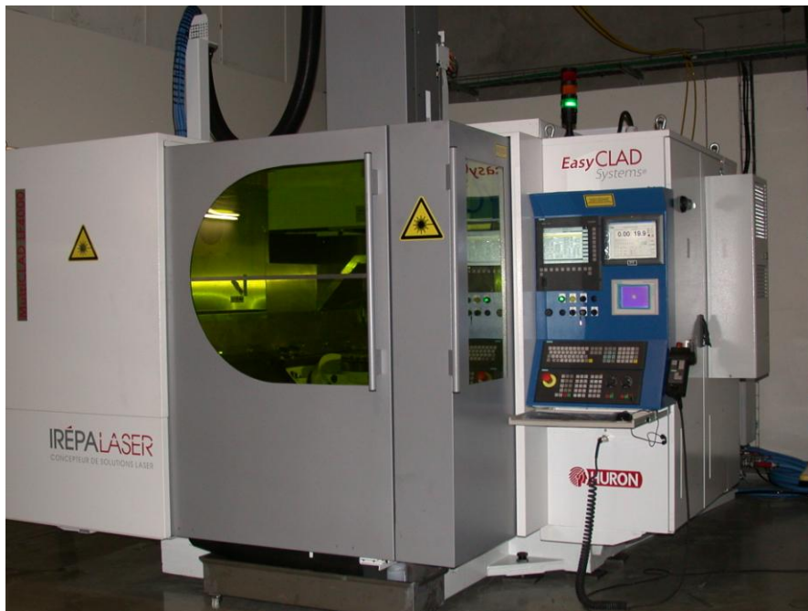
Figure 62 : Machine CLAD de projection de poudre de l'IRCCyN
