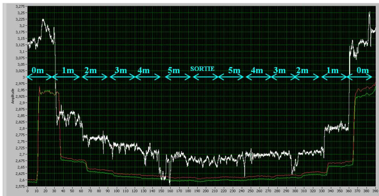
FIGURE 2.43 – Comparaison signal sans boîtier (courbe blanche) et avec boîtier (courbes rouge et vert)
