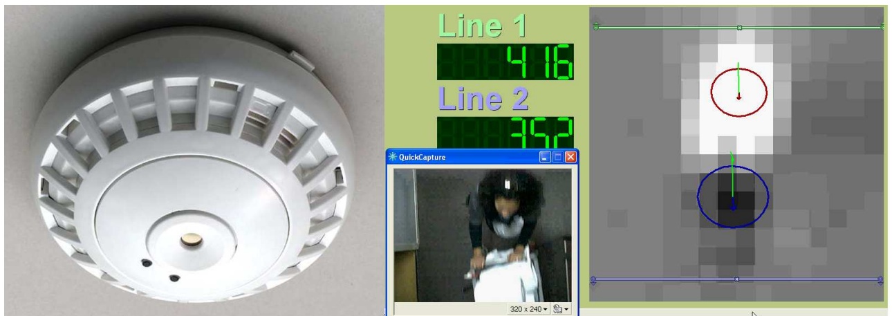
FIGURE 1.13 – a) à gauche, capteur de IRISYS - b) à droite, une scène de passage vue par une webcam et le capteur IRISYS (image basse résolution)
