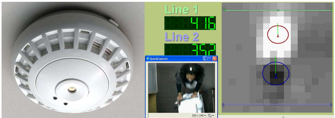
FIGURE 1.13 – a) à gauche, capteur de IRISYS - b) à droite, une scène de passage vu par une webcam et le capteur IRISYS (image basse résolution)
