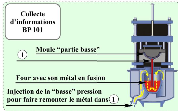
Figure 7 : Schématisation d'une presse basse pression
