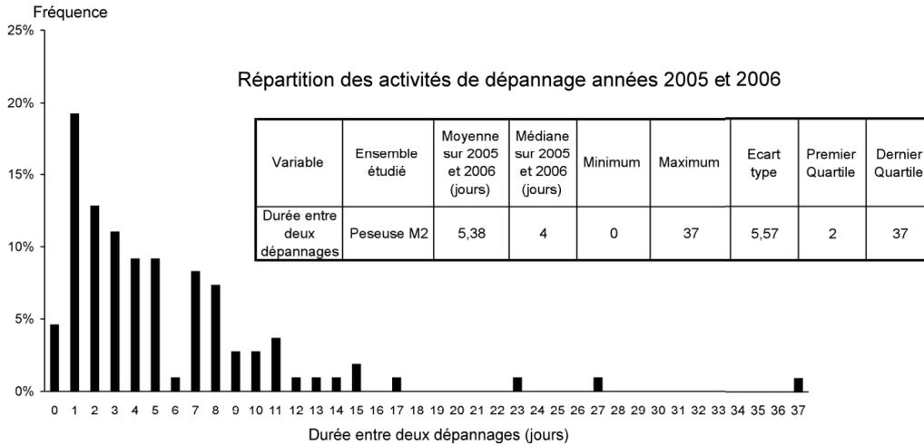
**Figure 37 : Répartition des pannes, mesures de tendance, de dispersion et d’emplacement (peseuse M2)**
