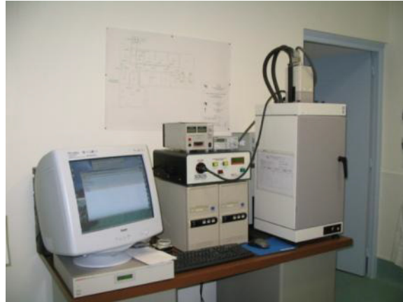
Figure 1.8 : Système utilisé pour l'acquisition des images de bioluminescence (Hamamatsu Macroscopic Imaging AEQUORIA system).
