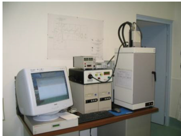
Figure 5.1 : Image du système d'acquisition Hamamatsu (Macroscopic Imaging AEQUORIA system).
