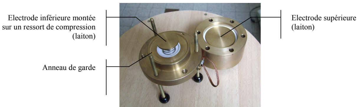
Figure 26 : Second modèle de cellule de spectroscopie diélectrique : électrodes planes en laiton et ressort de compression sur l'électrode inférieure.
