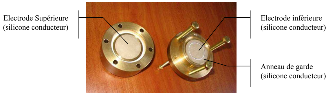
Figure 25 : Premier modèle de cellule de spectroscopie diélectrique (électrodes souples en silicone conducteur)
