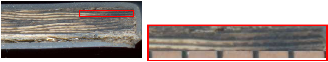
Figure 71 : Observations de la profondeur d'oxydation (hors de la fissure). Echantillon de classe F vieilli 1450 h, à 155°C sous 2,3 bars d'O 2 .
