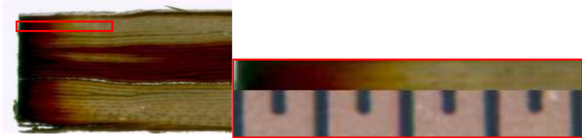
Figure 66 : Observations de la profondeur d'oxydation (hors de la fissure). Echantillon de classe F vieilli 1450h, à 155°C sous 2,3 bars d'O 2 .
