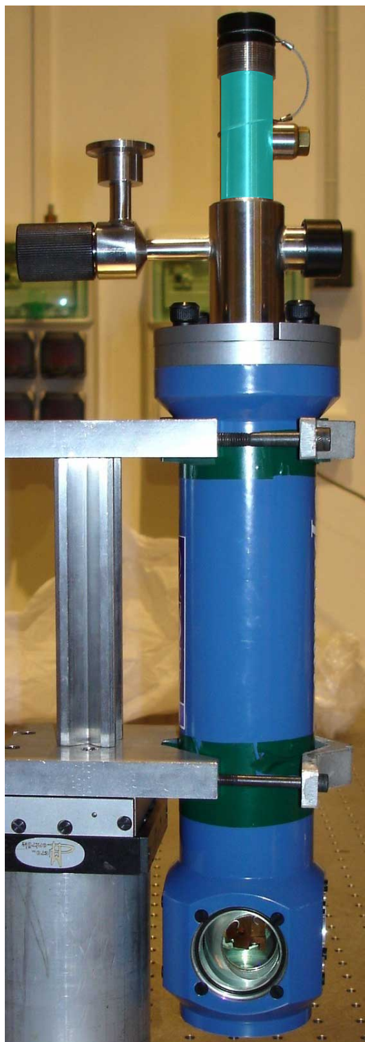
FIGURE 7.6: Cryostat de l'amplificateur. La zone colorée en bleu-cyan correspond à la partie se refroidissant en premier.
