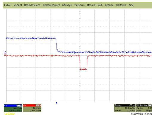
**FIG. 2.5** – Mesure du temps mort du DFC : les signaux entrants étaient séparés de  $34.75\text{ ns}$  et seul le premier signal a été discriminé
