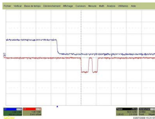
FIGURE 2.4 – Mesure du temps mort du DFC : les signaux entrants étaient séparés de 34.80\text{ ns} et les deux signaux ont été discriminés
